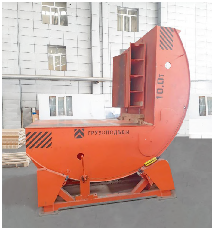
Кантователь для цилиндрических грузов с электроприводом грузоподъемностью 10,0 тонн для предприятия в г. Баку.
