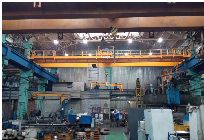
Кран мостовой опорный двухбалочный с электроприводом грузоподъемностью 10,0 тонн и длиной пролета 22,5 метров с подвесным электрическим кантователем грузоподъемностью 4,0 тонны и длиной пролета 4,0 метра для предприятия в Ростовской области.
